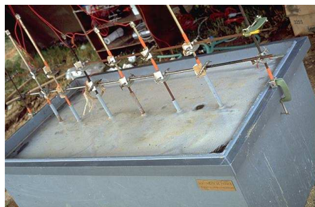
Cuve à électrolyse utilisée pour les plombs de Ploumanac'h (photo DRASSM)
